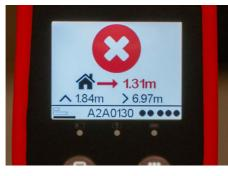
Ein Hochvolt-Warnsystem am Korb schützt Bediener vor Kontakt mit Stromleitungen auch bei schlechter Sicht uns sorgt so für mehr Sicherheit.
